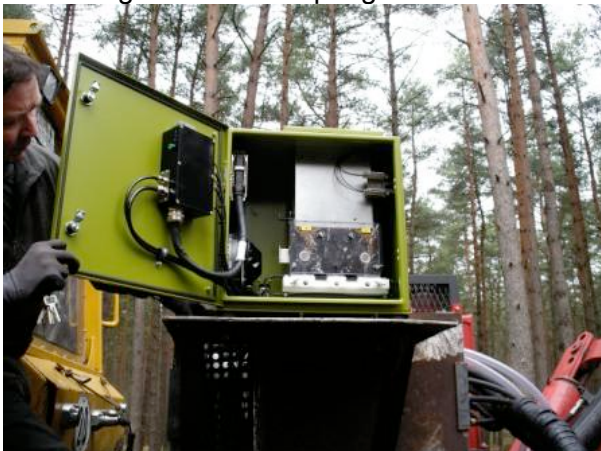
Abbildung 02: Blick in die Selektiereinrichtung des Säaggregates S35.a.
