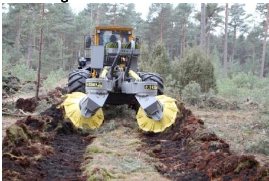
Abbildung 01: Scheibenpflug T26.a an John Deere 548 E beim Anlegen von Pflanzstreifen.
